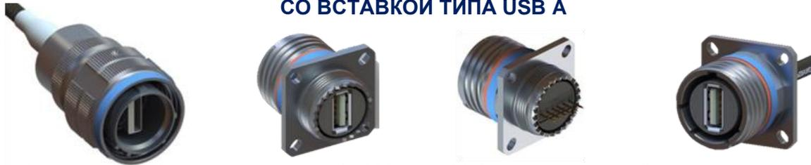
Соединители цилиндрические СКЦ102 с USB2.0 (тип A) вставкой, предназначены для подключения периферийных устройств к вычислительной техники с обеспечением обмена данными со скоростью передачи информации до 480 Мбит/с.
