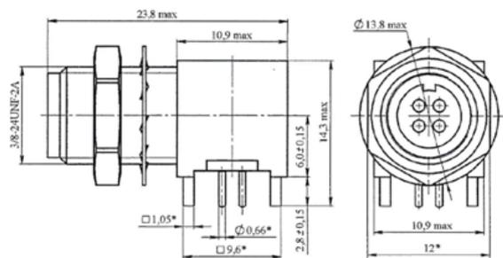
**Механический монтаж. Размеры в мм.**
