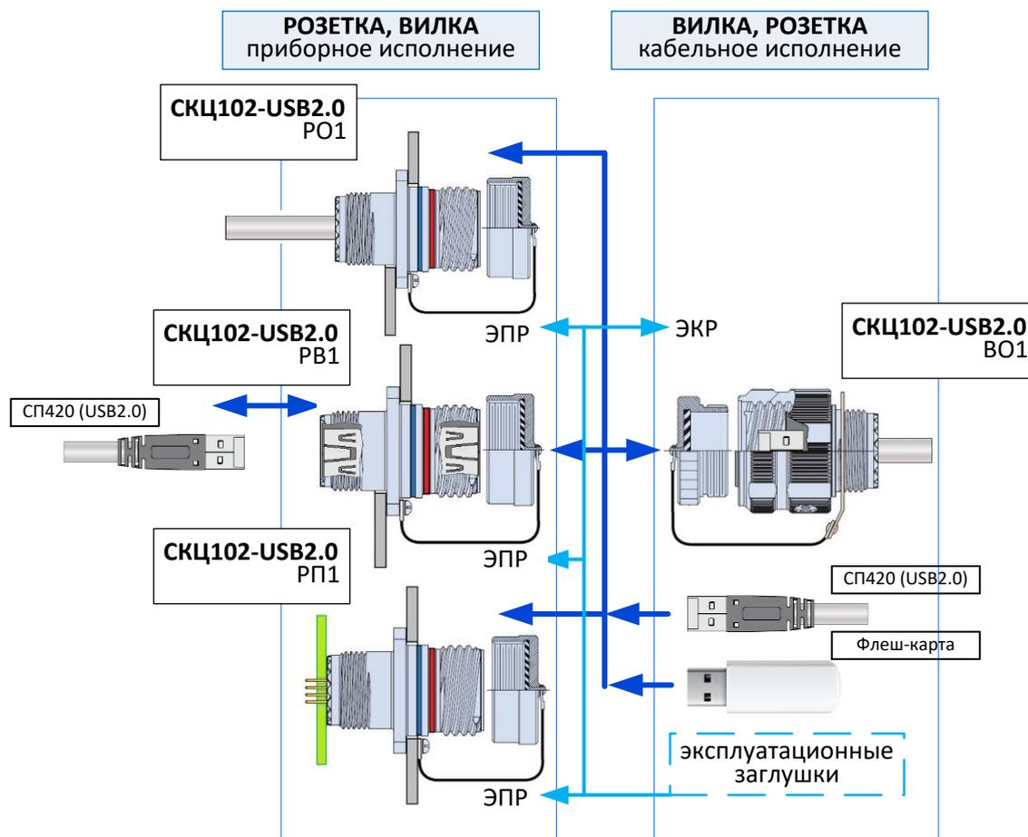
Соединители СКЦ102 с USB-вставкой, предназначены для подключения периферийных устройств к вычислительной техники с обеспечением обмена данными со скоростью передачи информации 480 Мбит/с.
