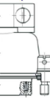
Розетка РП15 объемного монтажа с кожухом
